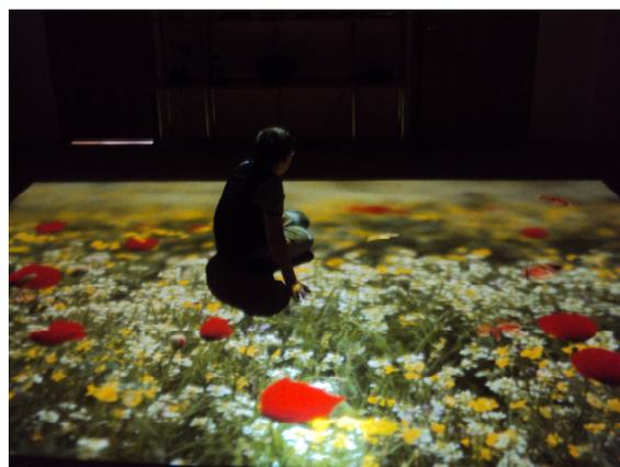
Только представьте, Вы идете по полу, а он вдруг оживает у вас под ногами, вы ступаете на водяную гладь, и от ваших ног расходятся круги. Эта проекционная система может использоваться на полу, на стенах и перегородках в виде разнообразных эффектов, где конечно используется трехмерная компьютерная графика.
